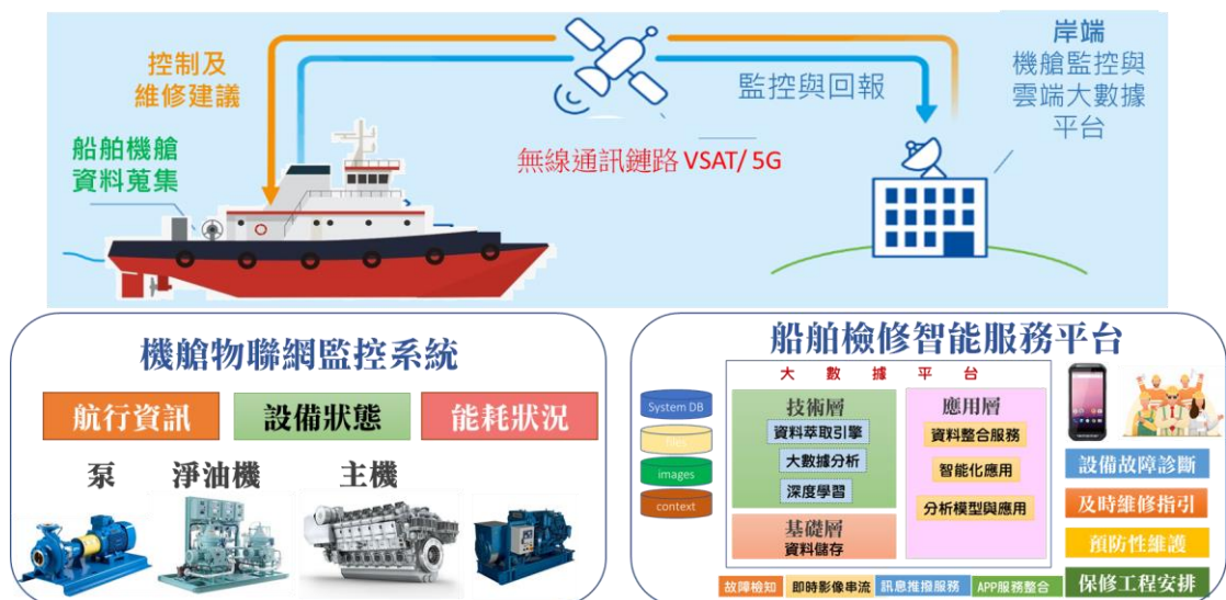
圖 6. 船舶機艙物聯網與船舶數據分析自動監控可視化數據管理平台
